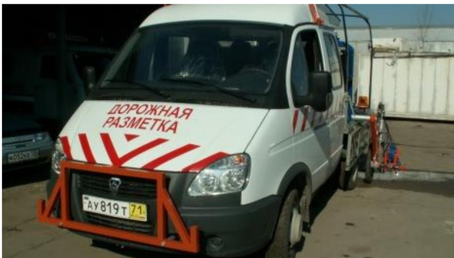
Окрасочное оборудование ОРД-1 предназначено для нанесения дорожной разметки быстросохнущими эмалями безвоздушным способом и устанавливается на шасси грузовых автомобилей. Оборудована покрасочным агрегатом V11 Г (США) с безвоздушным методом нанесения краски под давлением до 240 атм. и расходом краски до 24,0 л/мин.
