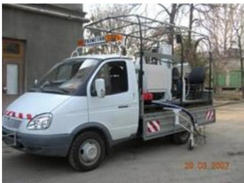
Основным продуктом компании на исследуемом рынке является машина для дорожной разметки РД-300 на шасси «Газель». Данная техника создана по принципу агрегатно-модульного проектирования разметочных машин, на основе съемного рамо-стенда (монтаж и демонтаж возможен, как вилочным погрузчиком, так и крановым оборудованием), позволяющий использовать базовый автомобиль во вне строительного сезона и по иному технологическому назначению. Проработаны вопросы безопасности при выполнении работ.
