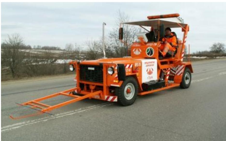
Разметочные машины МРД-7 оснащены оборудованием для безвоздушного нанесения краски фирмы "Г" и способны наносить три линии разметки одновременно. Гидравлический привод позволяет более точно выдерживать рабочую скорость, делает ход разметочной машины более плавным, а управление проще.
