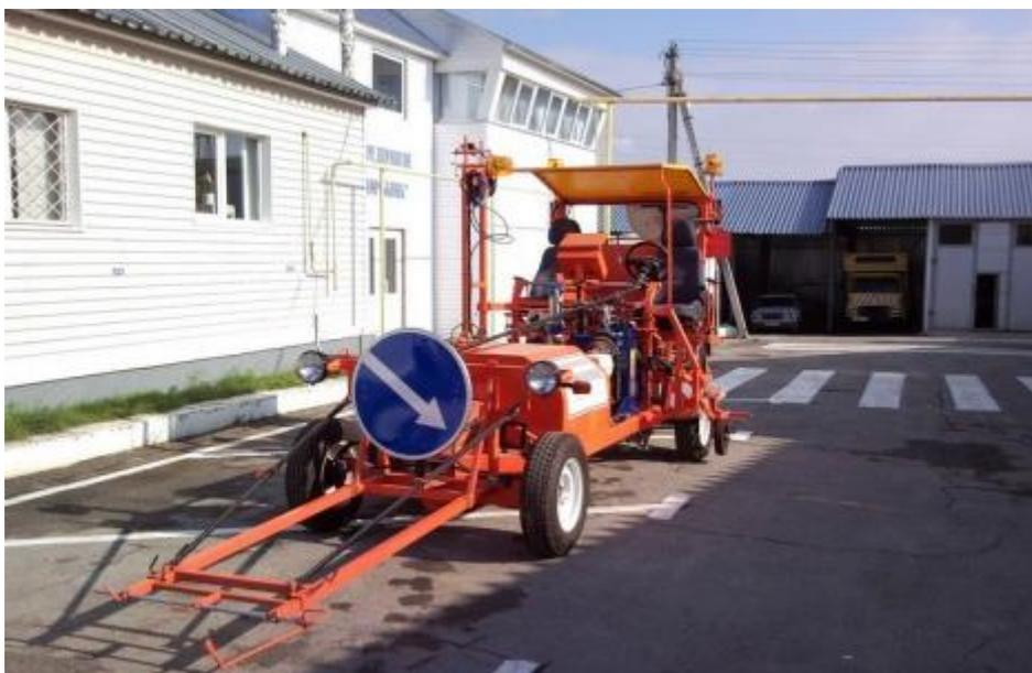
Оснащены оборудованием для безвоздушного нанесения краски фирмы "Г" и способны наносить три линии разметки одновременно.
