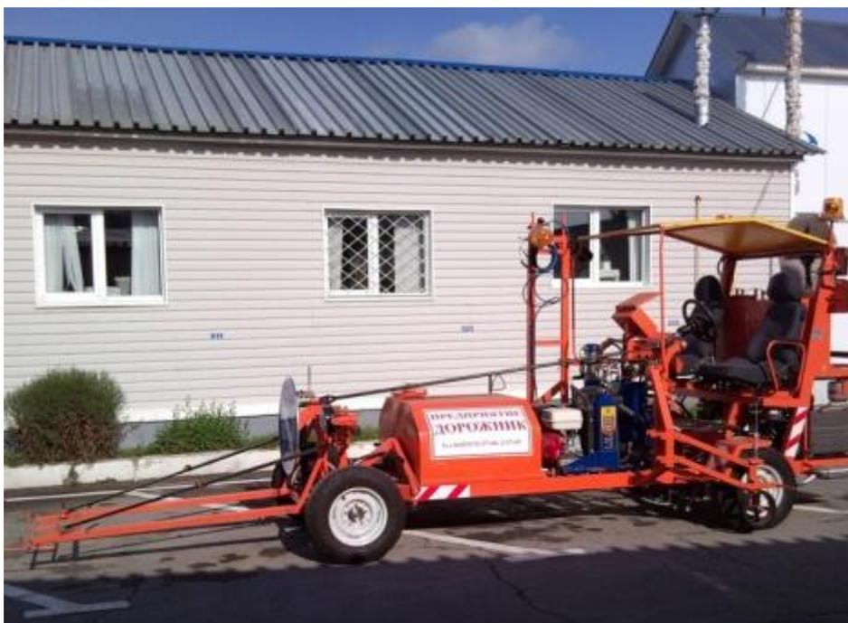
Разметочные машины МРД-5 оснащены оборудованием для безвоздушного нанесения краски фирмы "Г" и способны наносить три линии разметки одновременно.
