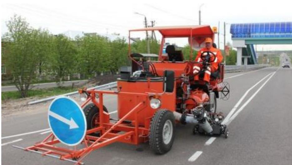
Машина разметочная МРД-8 предназначена для проведения разметочных работ термопластиком на автомагистралях, городских дорогах и дорогах местного значения, аэродромах. Оборудована экструдерной установкой фирмы W Германия с максимальной шириной линии разметки 400 мм.
